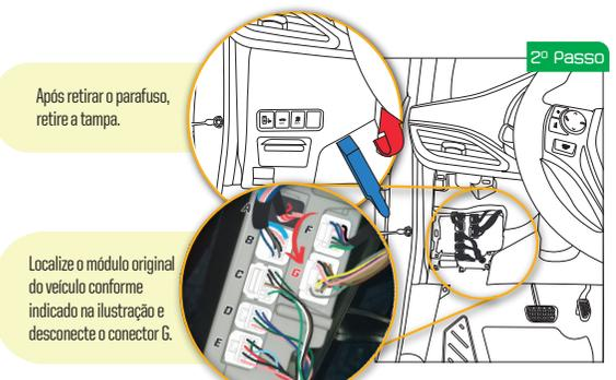
Localize o módulo original do veículo conforme indicado na ilustração e desconecte o conector G.
