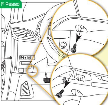
Retire os parafusos conforme indicado.
