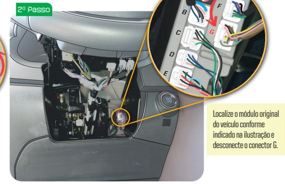
Localize o módulo original do veículo conforme indicado na ilustração e desconecte o conector G.
