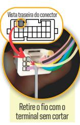
Retire o fio com o terminal sem cortar
