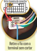
Retire o fio com o terminal sem cortar
