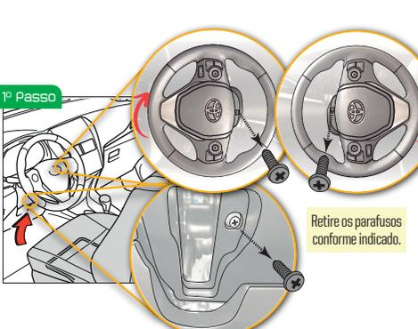
Retire os parafusos conforme indicado.
