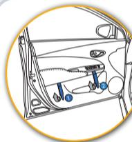
Remove o encosto de braço e o comando dos vidros utilizando uma espátula para não danificar o acabamento.
