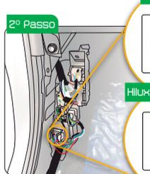
Após retirar a estrutura da soleira do motorista identifique o fio SINAL DA RÉ conforme a versão da Hilux e interligue-o ao fio BRANCO do produto.
