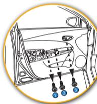
Após remover o encosto de braço e o comando dos vidros, retire os parafusos.
