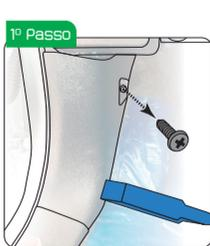
Retire o parafuso conforme indicado.
