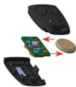
**Atenção:** Use somente bateria CR2032 de procedência confiável. Ao remover a bateria, cuidado para não danificar a placa. Descartar a bateria em local adequado.
